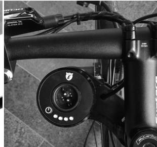
Akku korrekt eingesetzt und angeschaltet
