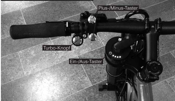
Bedienungselemente der Antriebsschwinge mit Bullhorn-Lenker
